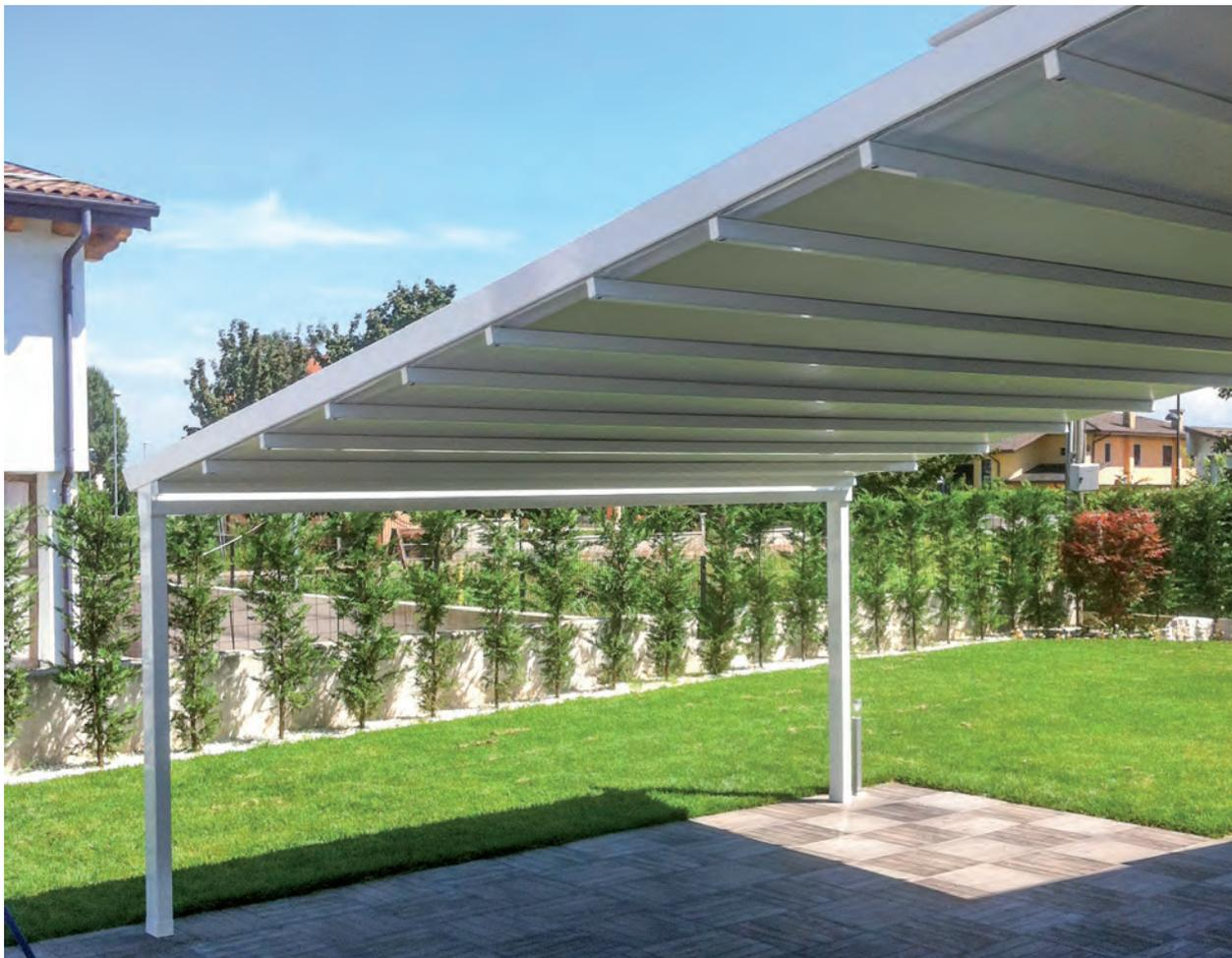
Le SoliNeptune est composé de traverses fixées au mur et de poteaux en façade pour faire la liaison au sol. La toile est d'une seule pièce, les joints latéraux conditionnent l'eau à descendre par gravité dans le chéneau frontal, puis elle s'écoule au sol via les poteaux frontaux. Son système d'ouverture / fermeture est silencieux, la manœuvre des chariots montés sur roulement à billes se fait grâce aux courroies crantées dissimulés dans les poutres latérales (et l'intermédiaire si 2 travées).
